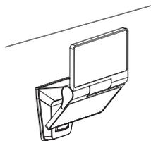
Le détecteur devra être orienté en direction des personnes ou véhicules à détecter. Afin de ne pas provoquer de fonctionnements intempestifs, la zone de détection devra être exempte de corps pouvant entrer naturellement en mouvement (par exemple des branchages).
